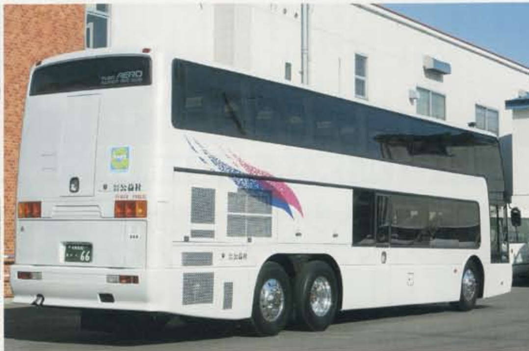
リアはI・II型当時と大きく変わっていないが側面後部のルーバー形状が変更された。非常口の位置は通路位置に合わせて、3列シート車は右寄りに、4列車は中央にそれぞれ設置
