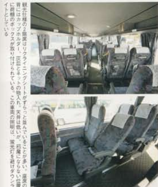
ノンステップの1階は1段高い位置に座席を取り付けている。座席配置は各車、個性が出る。この車内では、前向きな座席は基本的に普通車と変わらない。ボルトクローラーは中ドア部分に取り付けられているが、床面は大きく、普通車時の足の邪魔にならないよう、下部を切り欠いたスタイルとなっている
