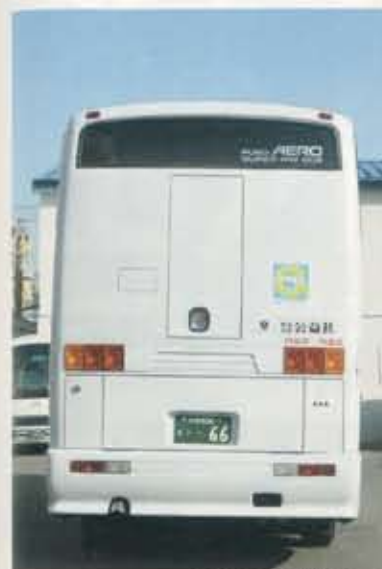
リアはI・II型当時と大きく変わっていないが側面後部のルーバー形状が変更された。非常口の位置は通路位置に合わせて、3列シート車は右寄りに、4列車は中央にそれぞれ設置
