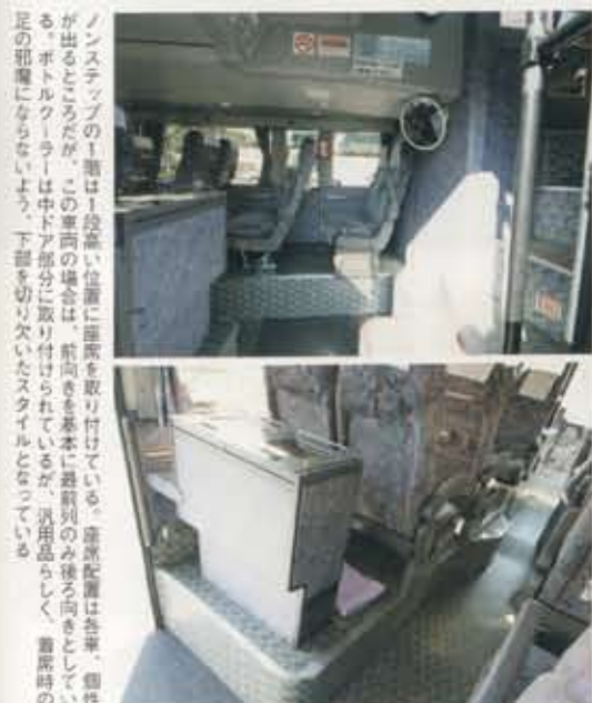
観光仕様の座席はリクライニングシートがずらりと並んでいて、座席の背にはカッパホルダー、灰皿とネットの物入れ、天井は低い。邪魔にならない位置に高級のボックスが取り付けられている。この車内の照明は、観光用と違ってダウンライトが多い。深夜の運行時には照明を落とす必要がある
